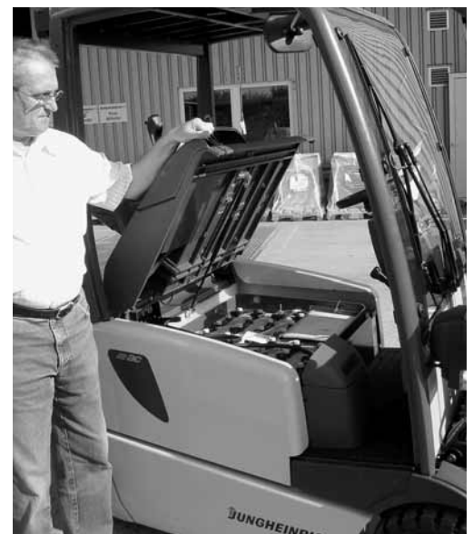
Figure 5: soulèvement du couvercle des coffres lors de la charge afin d'éviter l'accumulation de gaz explosibles.
