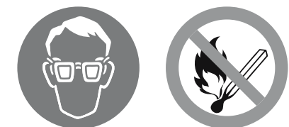
Figure 10: signaux de sécurité obligatoires pour les postes de charge.
